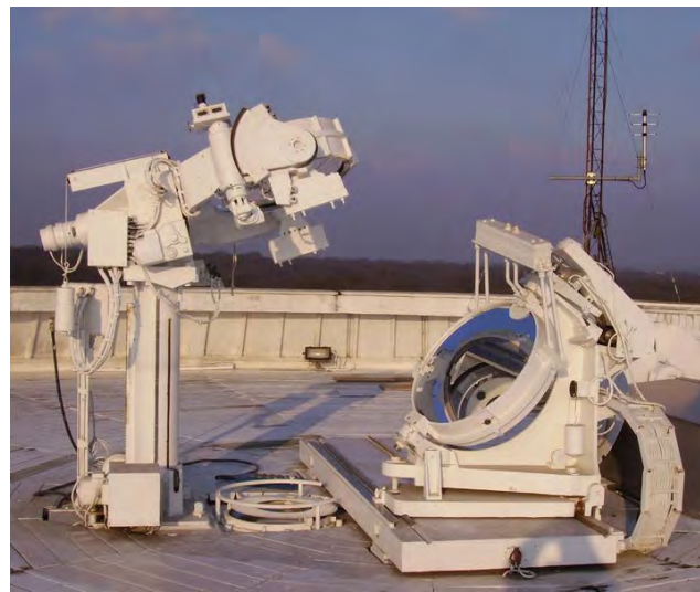
Σχήμα Α'.5: Σχηματική διάταξη ηλιοστάτη για κάθετο ηλιακό τηλεσκόπιο (αριστερά). Ο ηλιοστάτης του ηλιακού πύργου του αστεροσκοπείου της Meudon (δεξιά).
