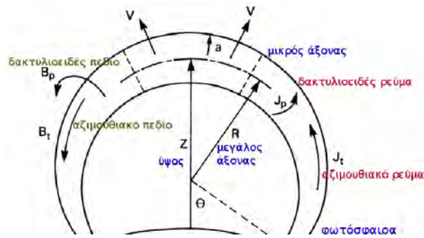
Σχήμα 11.1: Αναπαράσταση σχοινοῦ μαγνητικής ροῆς με σχήμα μισῆς συμπρέλας. Το σχοινί μαγνητικής ροῆς ἔχει μεγάλο ἄξονα R , μικρό ἄξονα a και μέγιστο ὕψος του μεγάλου ἄξονά του Z . Σημειώνονται ἐπίσης τα αξιμουθιακά και δακτυλιοειδή ρεύματα και μαγνητικά πεδία με δείκτες t και p ἀντίστοιχα (τροποποιημένο ἀπό Chen et al. , 1989).
